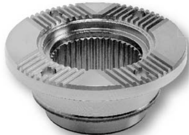
Form nach DIN ISO 8667 – Induktivgehärtete und drallfrei geschliffene Dichtringlaufbahn – Innenverzahnung – Kreuzverzahnung 70°
